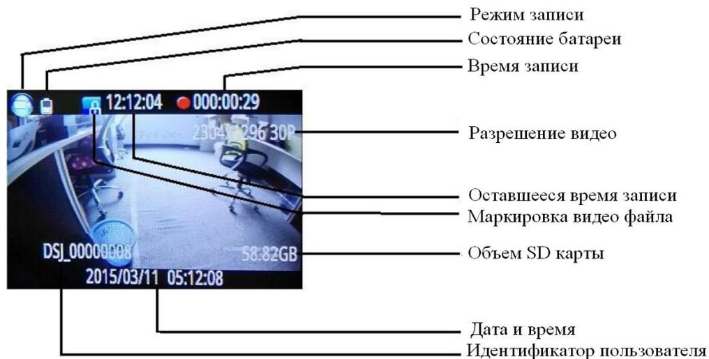
Рисунок 2 - Маркировка на LCD дисплее
